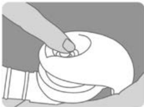
Para voltar à Fase de Estimulação, quando estiver na Fase de Extração, (1) empurre a ponta da haste em sua direção, (2) gentilmente pressione a alça e coloque-a no primeiro encaixe (de cima).
